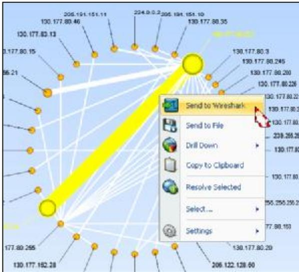
Beispiel: Im Kreisdiagramm lässt sich eine bestimmte Conversation markieren. Mit einem rechten Mausklick werden diese Daten vom Wireshark geöffnet, in einem neuen File abgespeichert oder detaillierter untersucht.
