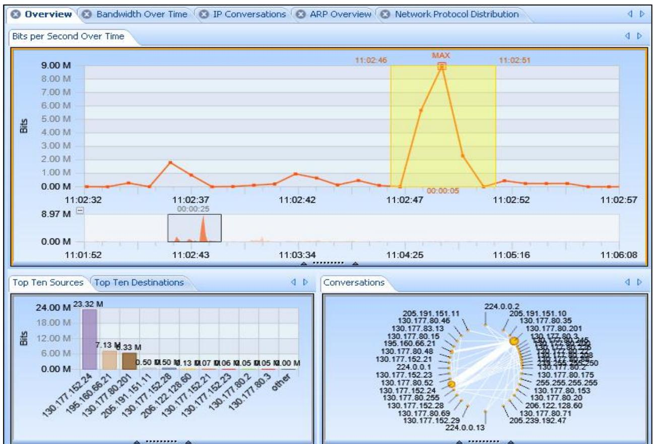
Verschiedene Views wie der Bandbreitenverlauf über die Zeit, Top-Talkers sortiert nach Volumen oder das beliebte Conversation-Kreisdiagramm zeigen im Überblick den Verlauf in einem Tracefile. Aus jedem dieser Diagramme können Bereiche markiert und mit einem Mausklick zur genaueren Analyse an den Wireshark geschickt werden.
