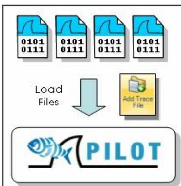
Wireshark Tracefiles werden durch einfaches Click & Drop in die PILOT Software importiert. Eine weitere Möglichkeit ist auch, vom PILOT direkt den Wireshark zu starten und Daten online darzustellen.
